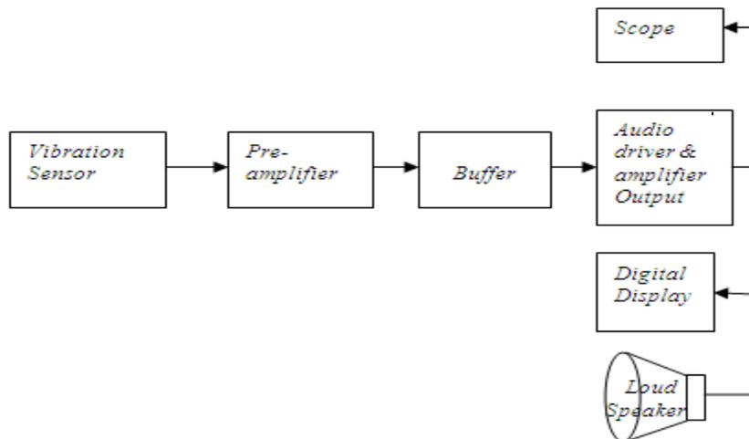
FIG: 2 SCHEMATIC REPRESENTATION OF THE CIRCUIT
