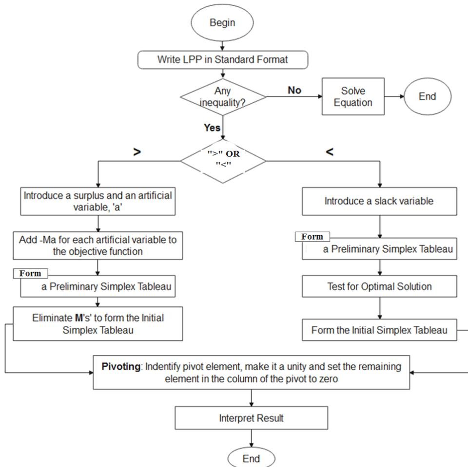
**Fig. 2:** Simplex Method Flowchart
