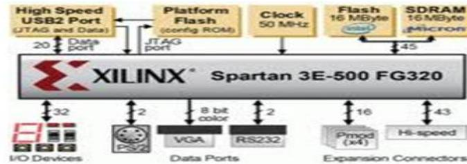
FIGURE6: FPGA ARCHITECTURE SPARTAIN 3E
